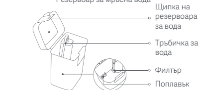
Резервоар за мръсна вода Щипка на резервоара за вода Тръбичка за вода Филтър Поплавък Резервоар за чиста вода
