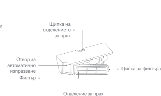
Бутон за нулиране Натиснете и задръжте за три секунди за възстановяване на фабричните настройки Натиснете и задръжте за 10 секунди за принудително изключване Капак Щипка на отделението за прах Отвор за автоматично изпразване Филтър Индикатор за Wi-Fi Включено: има връзка с Wi-Fi Мигащо: изчакване на връзка с Wi-Fi/свързване с Wi-Fi Изключено: няма връзка с Wi-Fi Щипка за филтъра Отделение за прах
